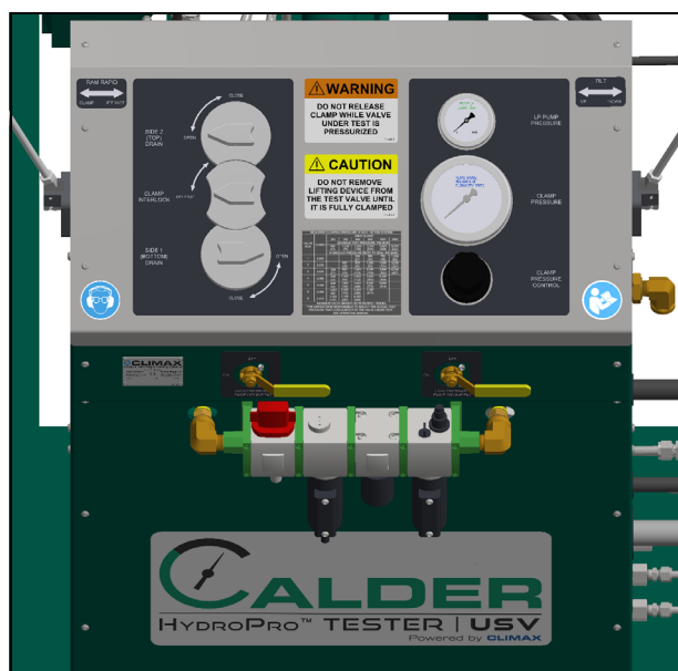
ABBILDUNG 1-1. PLATZIERUNG DER KENNZEICHEN AN DER KONSOLE
