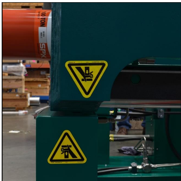
FIGURE 1-3. ARRIÈRE DU BOÎTIER DE SERRAGE ET EMPLACEMENTS DES ÉTIQUETTES SUR LE CHÂSSIS
