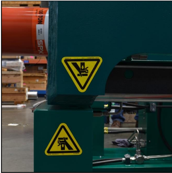
ABBILDUNG 1-3. KENNZEICHNUNG AN DER HINTEREN SEITE DES EIN- SPANNKASTENS
