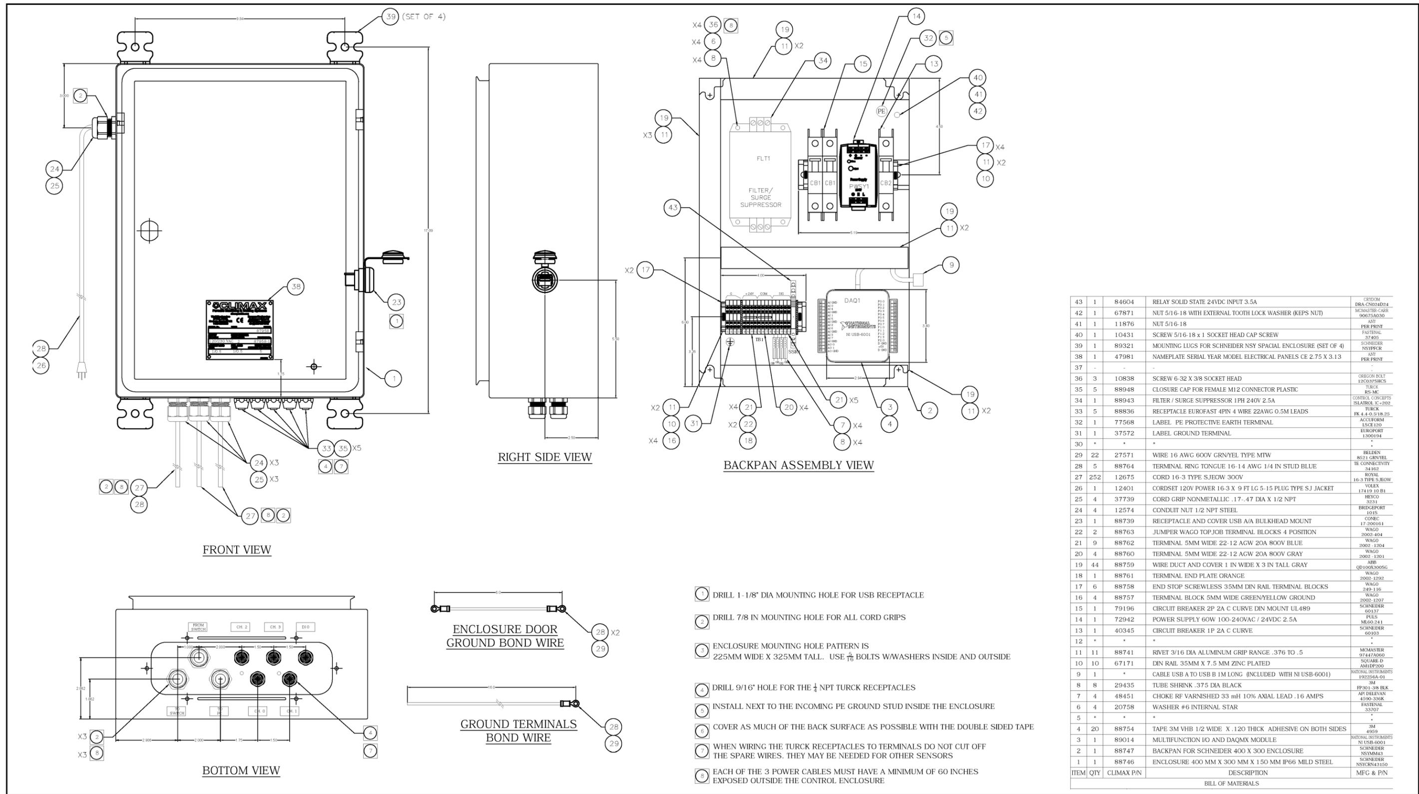
FIGURE B-3. CONTROL ENCLOSURE SCHEMATIC (P/N 87958)
