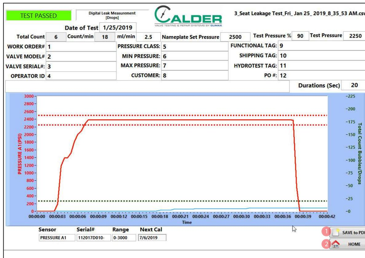
FIGURE 4-22. SEAT LEAKAGE REPORT INPUT SCREEN
