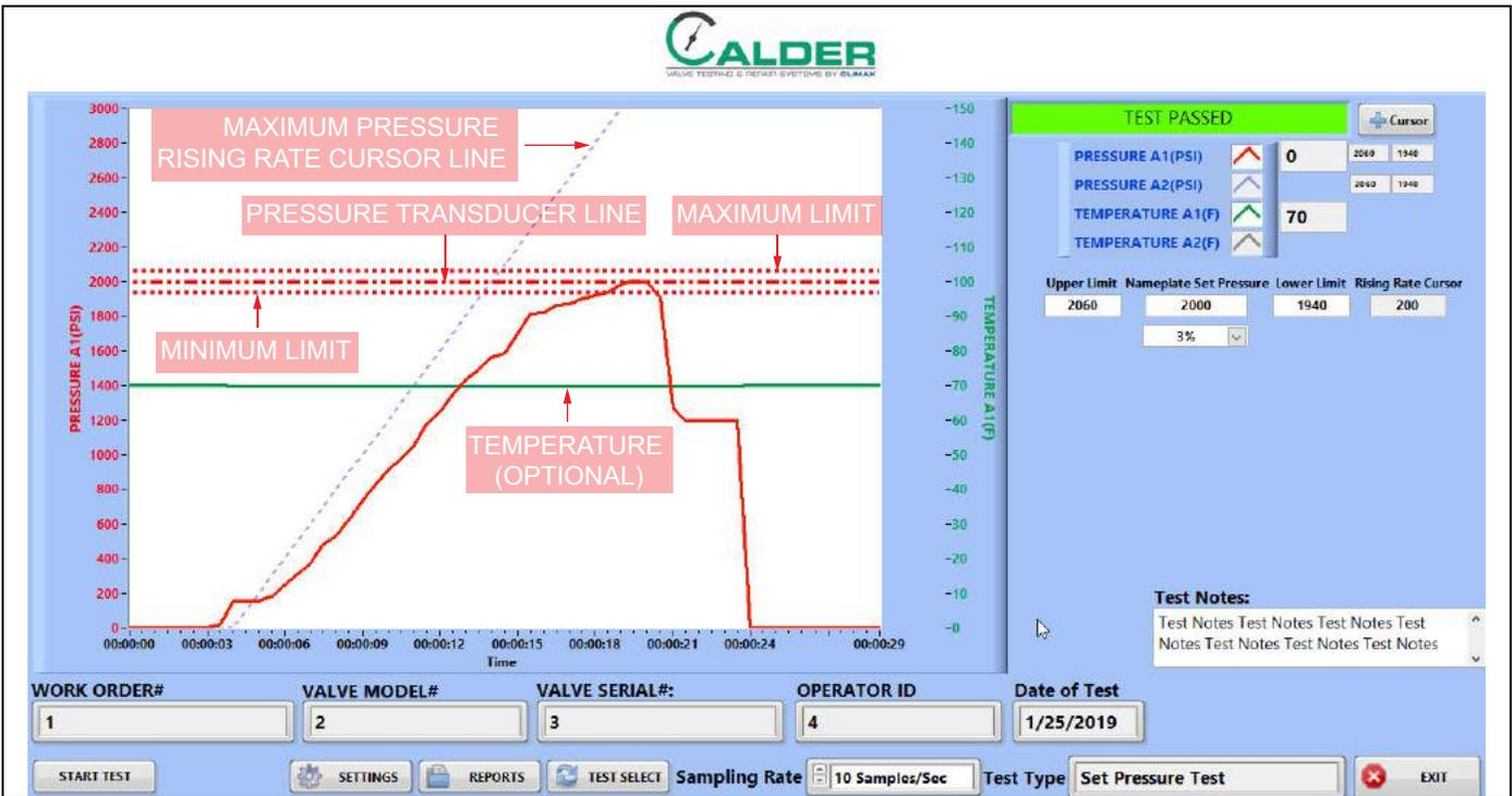
FIGURE 4-10. SET PRESSURE TEST SAMPLE
