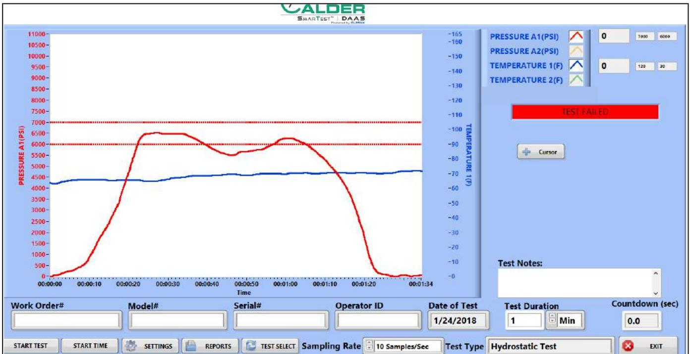
FIGURE 4-6. HYDROSTATIC TEST FAIL EXAMPLE
