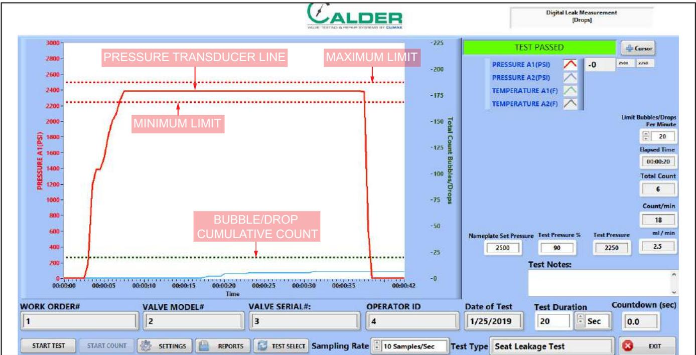
FIGURE 4-18. SEAT LEAKAGE TEST SAMPLE
