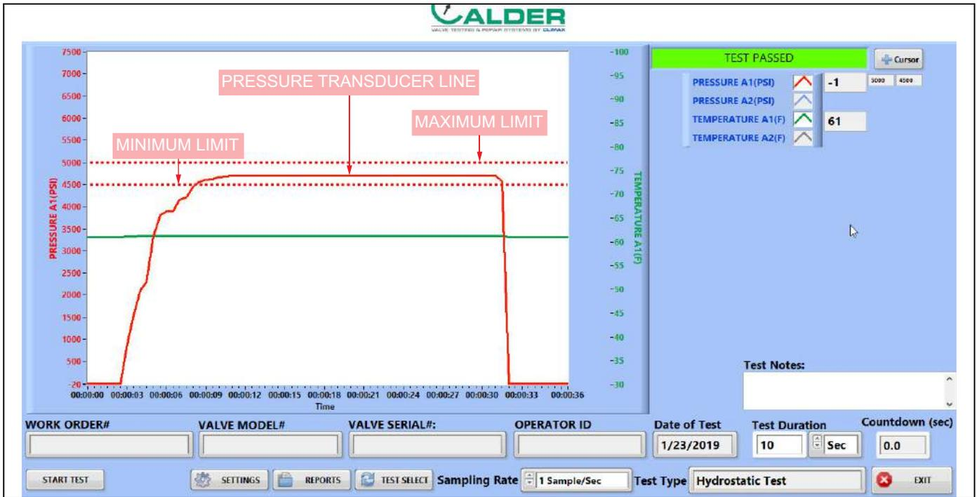
FIGURE 4-3. HYDROSTATIC TEST SAMPLE
