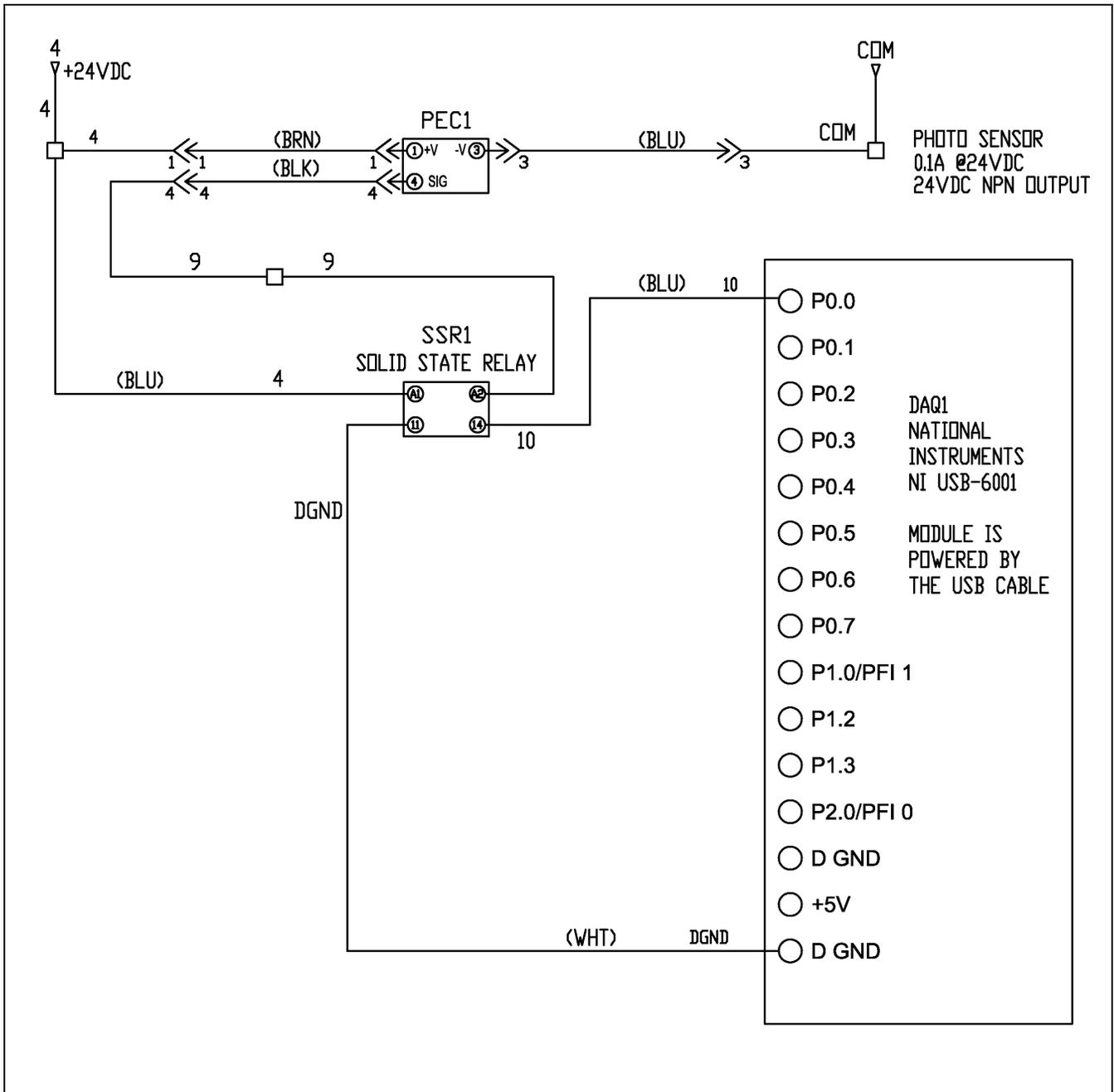
FIGURE B-2. CONTROL PANEL SCHEMATIC 2 (P/N 87958)
