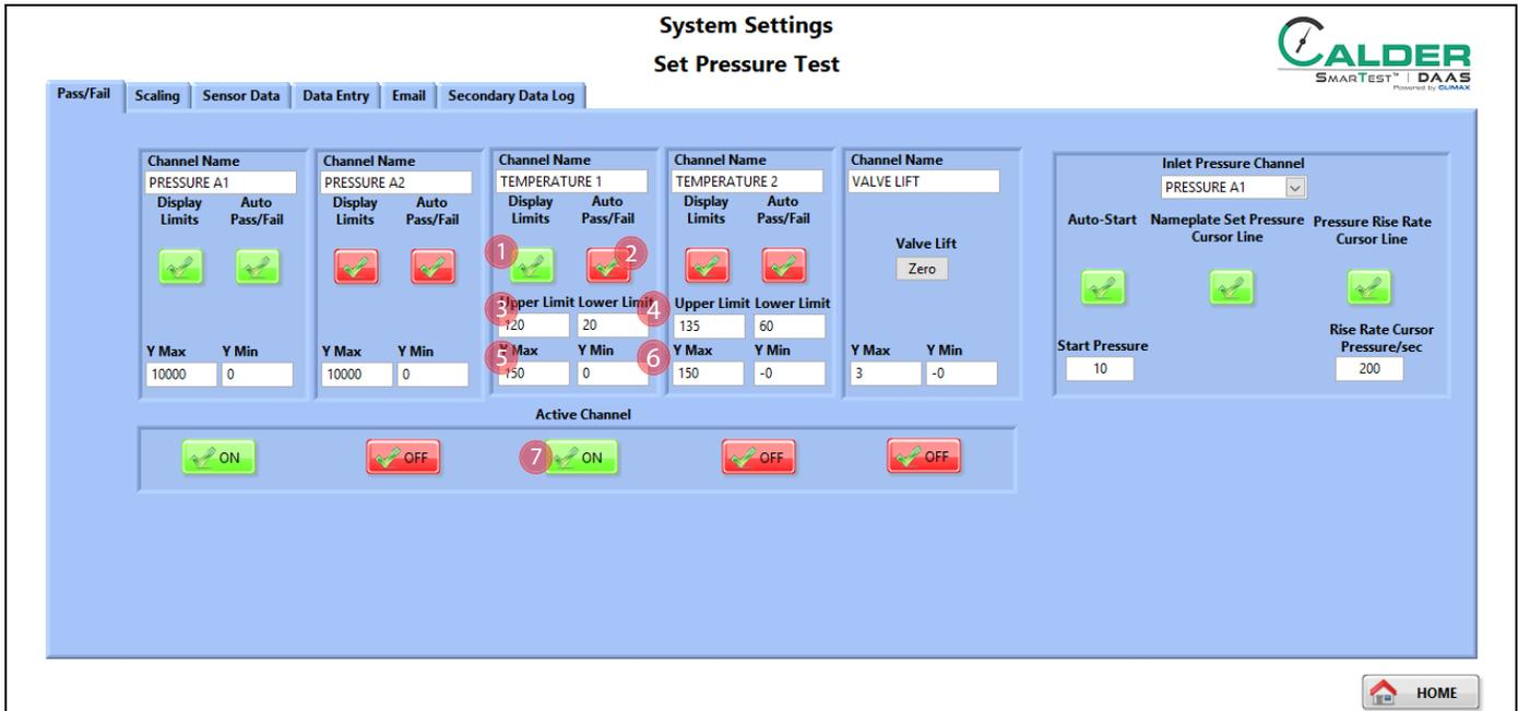
FIGURE 4-11. SET PRESSURE TEST PASS-FAIL CONFIGURATION SCREEN
