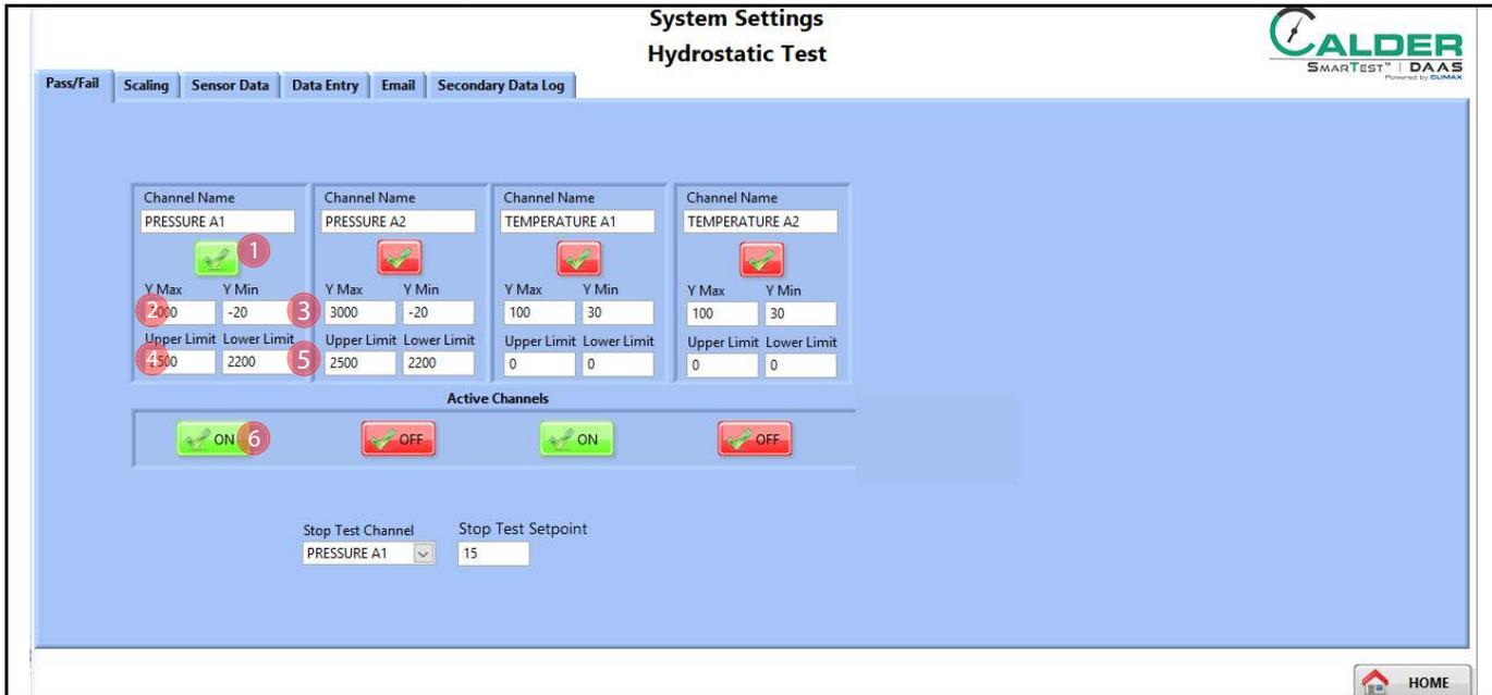
FIGURE 4-4. HYDROSTATIC TEST PASS-FAIL CONFIGURATION SCREEN
