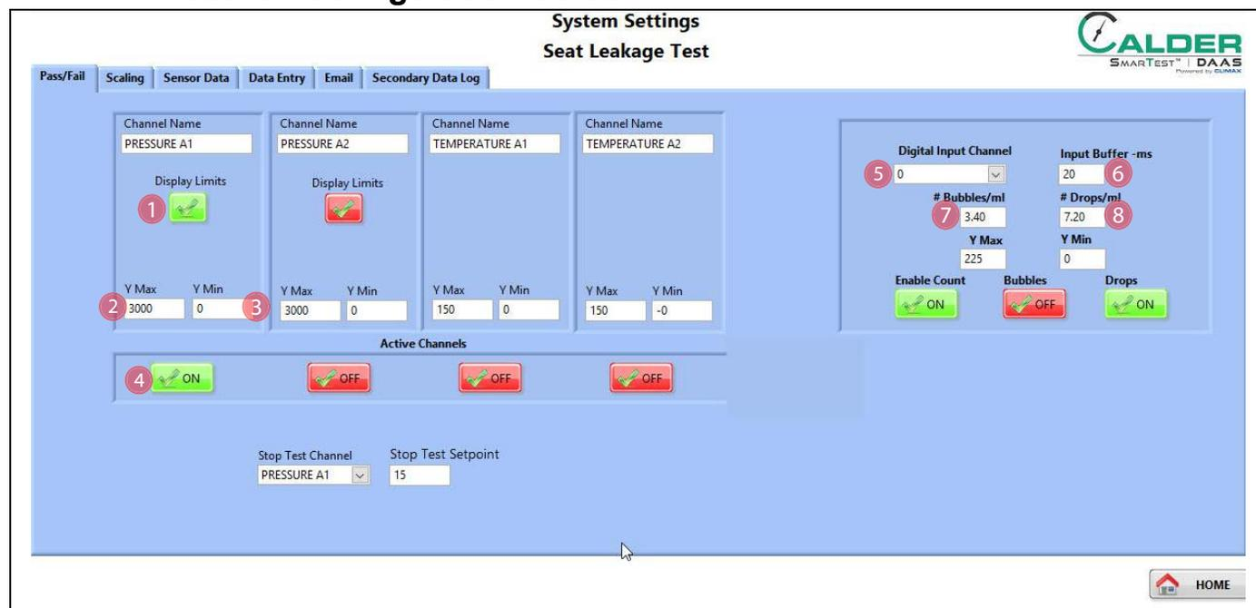
FIGURE 4-19. SEAT LEAKAGE PASS-FAIL CONFIGURATION
